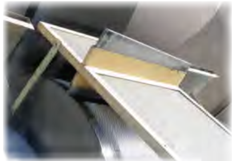
Sur les rouleaux de tourillon, le bloc est monté dans un support contre la surface rotative, utilisant la gravité pour permettre au poids du bloc de déposer du lubrifiant sur la surface portante. Cela maximise le transfert de graphite sur la surface portante, minimise l'usure des rouleaux et des bandages, et garantit des performances optimales sous toutes les pressions et températures.
